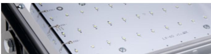
Ein anderer wichtiger Aspekt ist die LED-Betriebstemperatur. Sie finden auf dem Markt verschiedene Lösungen von LED-Chips in Kunststoff-Fassung (FR4), Aluminium- oder auch Keramik-Fassung. Je besser und schneller diese Materialien in der Lage sind, die Wärme von Chips abzuführen, desto besser die Lebensdauer dieser Lösung ist.
